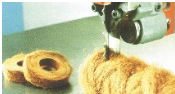
Tagliente Scallop Per materiali dove è necessaria una leggera penetrazione come la gomma, guarnizioni, pelle, cartone ondulato
