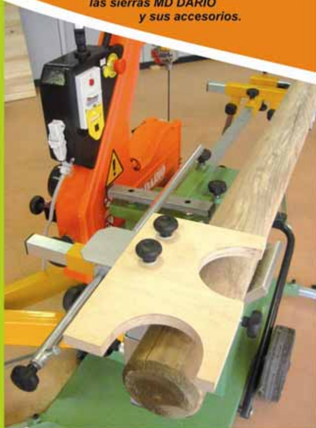
En la fotografía arriba: copiadora con ejemplo de copia de perfil
