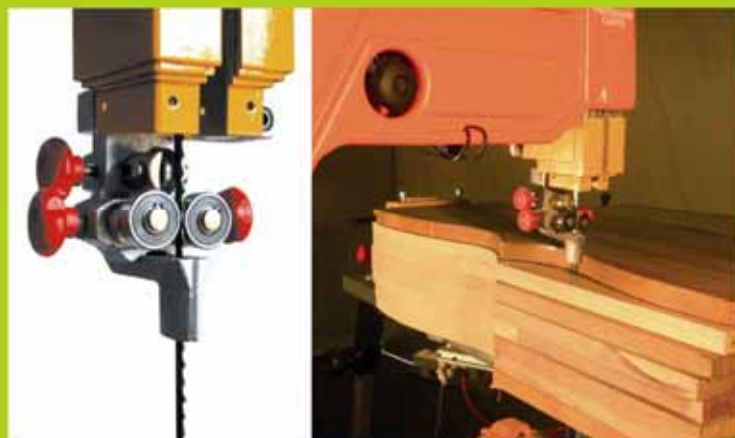
En la fotografía arriba: copiadora con ejemplo de copia de perfil
