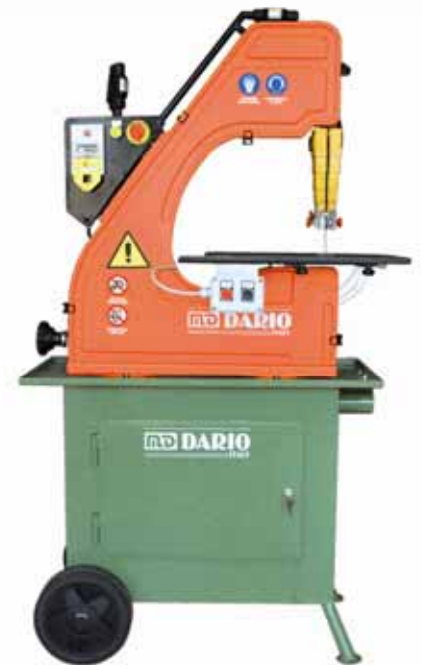
Foto oben: SN33 feststehende Werkbankausführung
