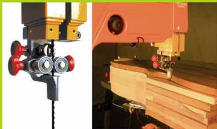
Na foto acima o copiador com um exemplo de cópia de molde
